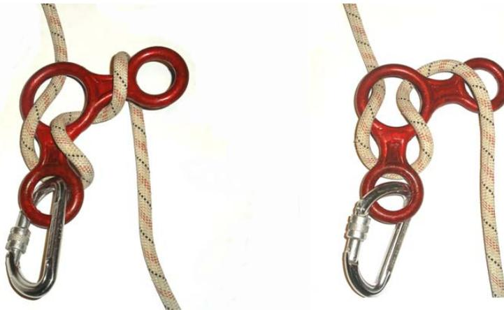
**Figura 11.** Posiciones de máximo rozamiento (izq.) y de rozamiento medio (dcha).
