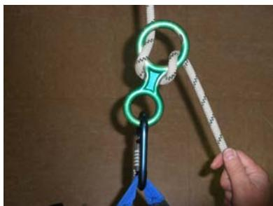
**Figura 3.** Descensor en *ocho* y su posición en técnicas de descenso.
