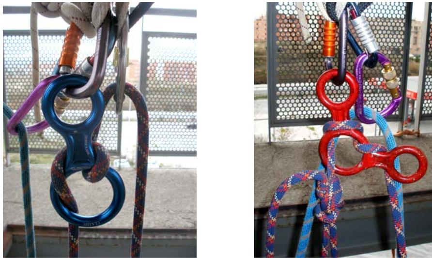
**Figura 6.** Prueba de rozamiento del descenso en ocho (izq.) y de la innovación (dcha.)
