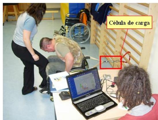
Figura 3. Posición del sujeto y situación de la célula de carga en los dos test de fuerza isométrica.
